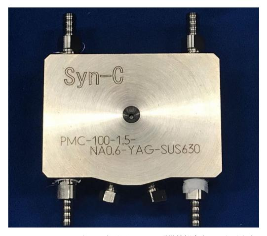
PMC-100-1.5-NAO.6 は 100MPa までの高圧下でラマン顕微鏡観察することが出来るセルです。作動距離 2.1 mm NA= $0.6 \text{ の対物 レンズ (オリンパス UIS2 LUCPPLFLN 40X等)が使用可能です。照明側もテーパー窓を使用し位相差観察が可能です。$
