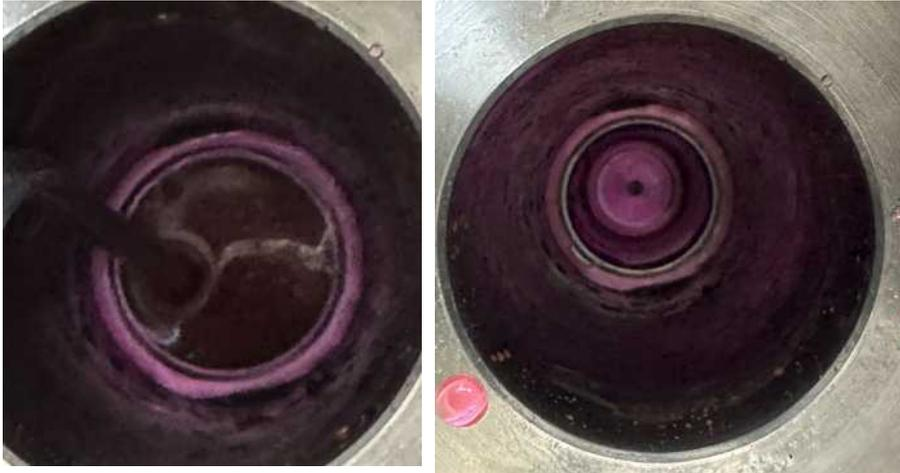
再度チューブを挿入し 圧媒を除去してください
