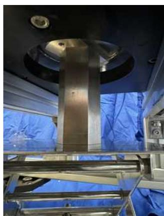
治具の突起がグランドナットの穴に一致するように調整して
